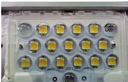
**Figura 6 – Lente com excesso de silicone**
