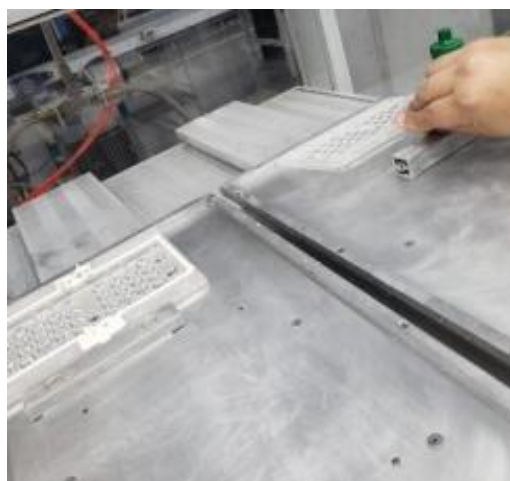
Figura 3 – Aplicação de silicone e posicionamento das lentes na máquina
