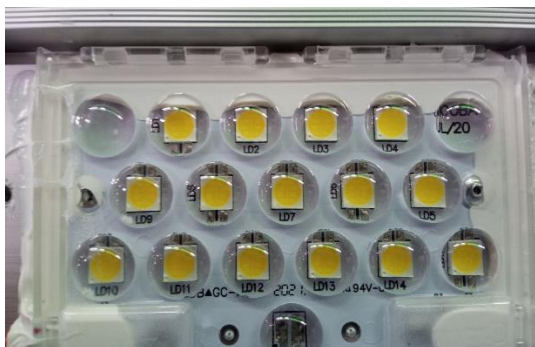
Figura 6 – Lente com excesso de silicone
