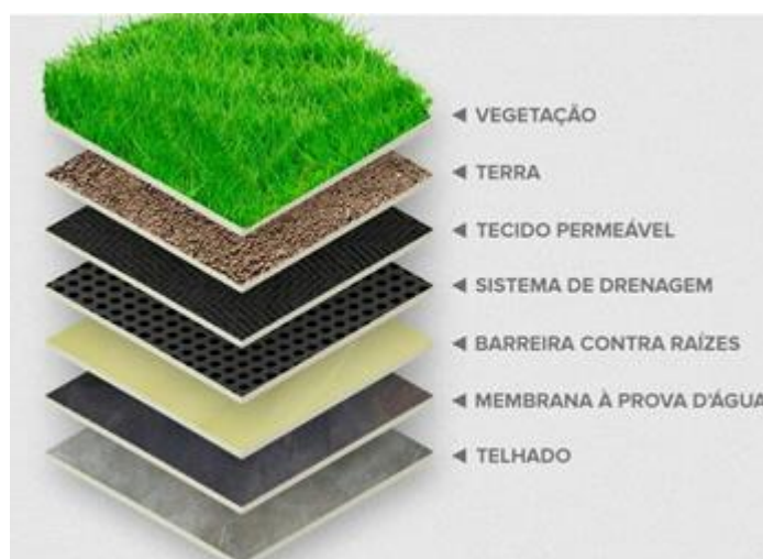
Figura 1 - Estruturas do telhado verde
